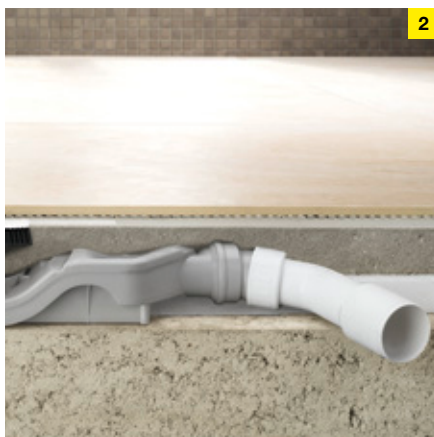
Obr. 2: extrémně plochý: speciální odtok pro sanace dokáže ponížít vestavnou výšku při sanacích až na pouhých 70 mm
