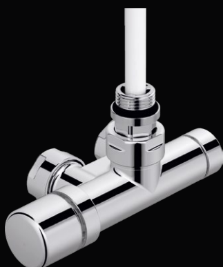
Set M pro vnější připojení – přívod vpravo Jednobodová armatura rohová 1/2", rozteč 50 mm, přívod vpravo, zpátečka vlevo
