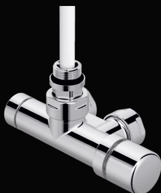
Set K pro vnější připojení – přívod vlevo Jednobodová armatura rohová 1/2", rozteč 50 mm, přívod vlevo, zpátečka vpravo
