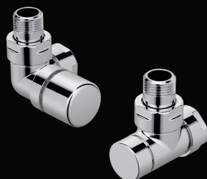
Set I pro vnější připojení – přívod vlevo Úhlový rohový ventil levý a rohové šroubení pro zpátečku 1/2"
